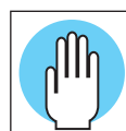
Simbolo che indica la temperatura superficiale sulla calotta T<70°C (dati rilevati a ta per esterni di 15°C) Cover's surface temperature T<70°C (ambient temperature data of 15°C)
